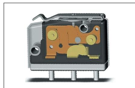
Рис. 6. Внутренняя структура выключателей серии KX
