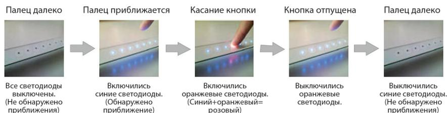
Рис. 2. Алгоритм работы встроенных светодиодных драйверов
