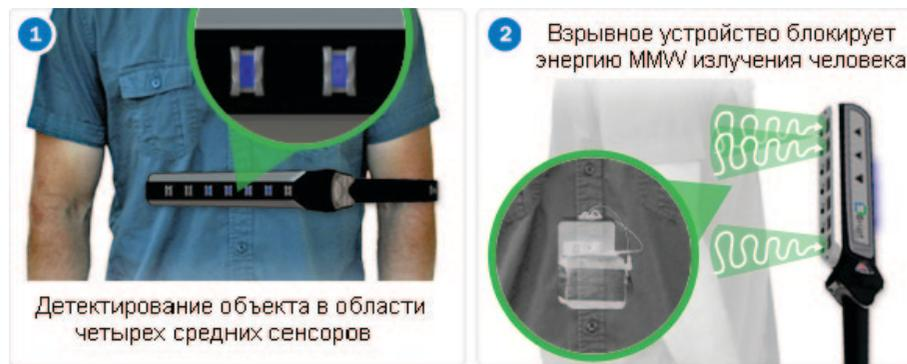
частей тела человека, индикатором обнаружения является светодиодная панель, содержащая семь сенсоров миллиметровых волн. Оно весьма компактно (размер 467×90×72 мм, вес 680 г), срок автономной работы без подзарядки встроенного аккумулятора – не менее 16 часов. Органы управления включают в себя кнопки включения с подсветкой зеленого, желтого или красного цвета в зависимости от уровня заряда батареи, выбора типа сигнализации (визуальная, звуковая или вибро) и сброса в первоначальные настройки.
