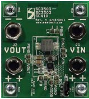
Рис. 5. Внешний вид демонстрационной платы на основе ИС SC3303
